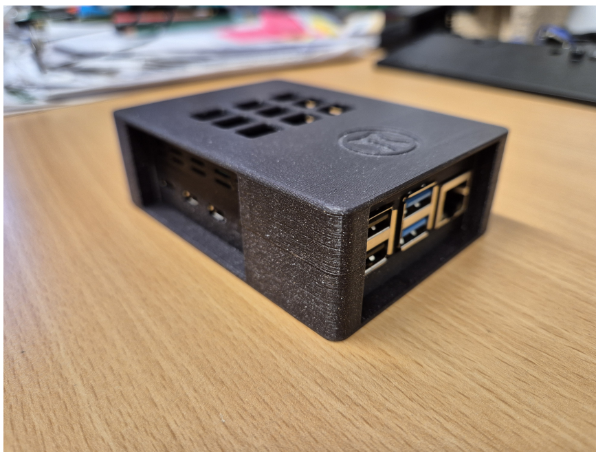
Obrázek 10.13: Tenký klient Raspberry Pi 4 [autor]
